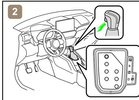
2. Coloque la palanca de cambios en la posición de estacionamiento (P). \* 1
